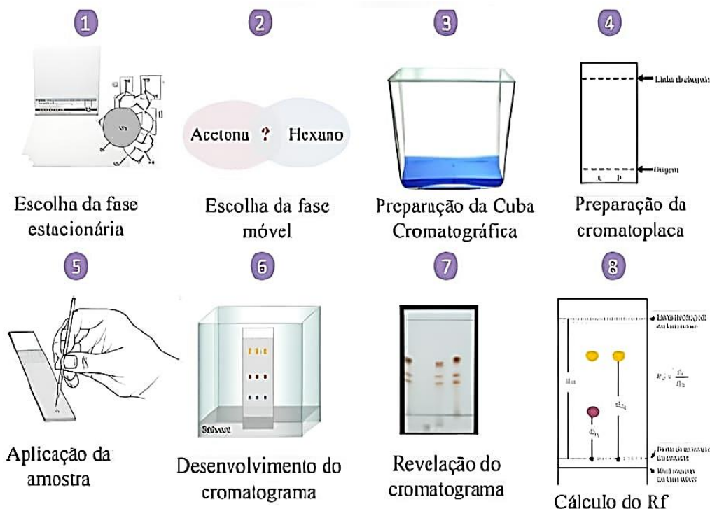
Figura 2 - Preparação de uma cromatografia em Camada Delgada
